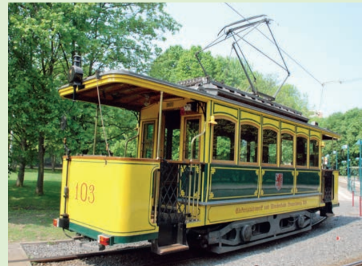
Der restaurierte und heute für Oldie-Rundfahrten genutzte TW 103 ist baugleich mit der ersten in Braunschweig eingesetzten Fahrzeugserie
